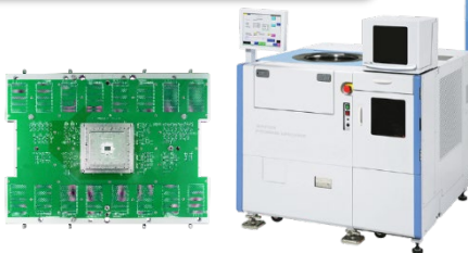
利用探針卡確保晶圓電氣特性與效能
